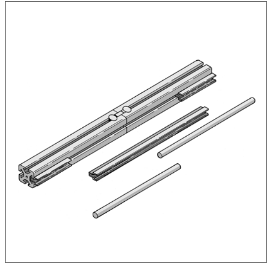
Роликовая направляющая может быть увеличена до любой длины
