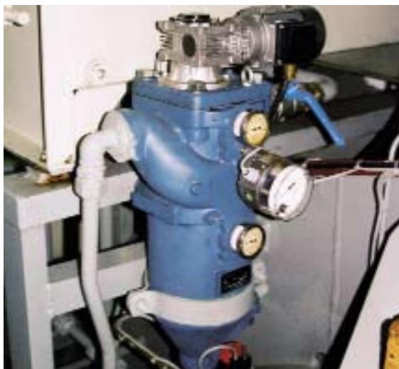
Автоматический фильтр с сегментом очистки внутренним давлением для фильтрации моторного масла на судах.
