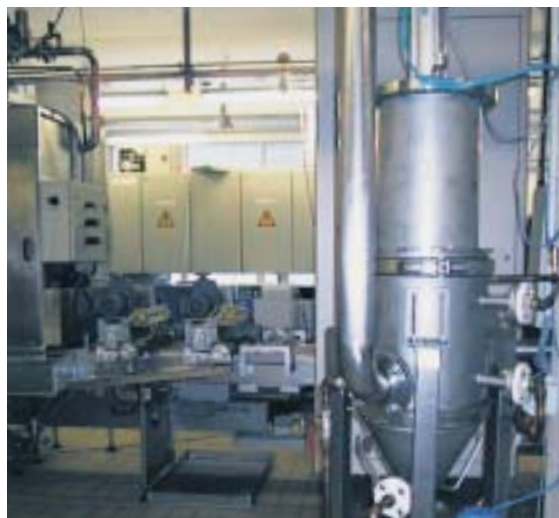
Автоматический кромоочный щелевой фильтр со скребковой очисткой для фильтрации шоколада.
