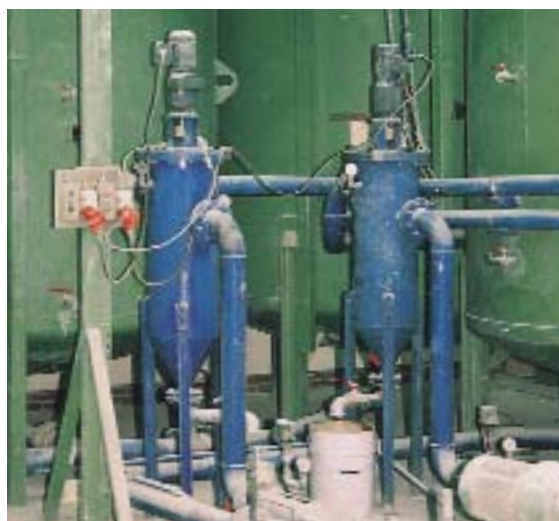
Автоматический кромоочный щелевой фильтр со скребковой очисткой для фильтрации клеев и адгезивов.
