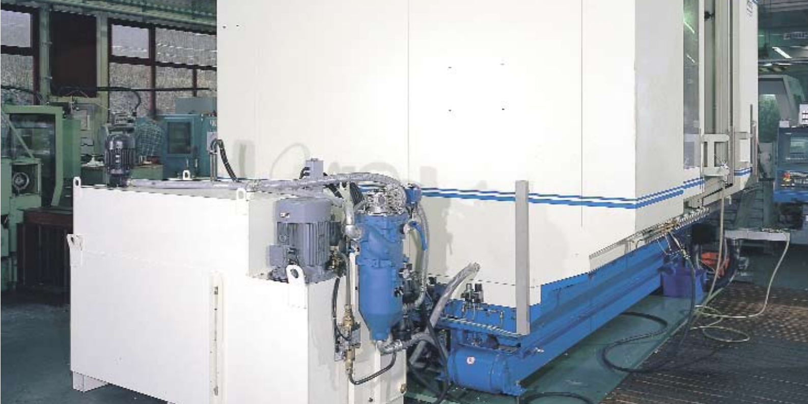
Автоматический фильтр для СОЖ в металлообрабатывающем центре.
